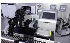
Distributeur de cellules en microplaque
