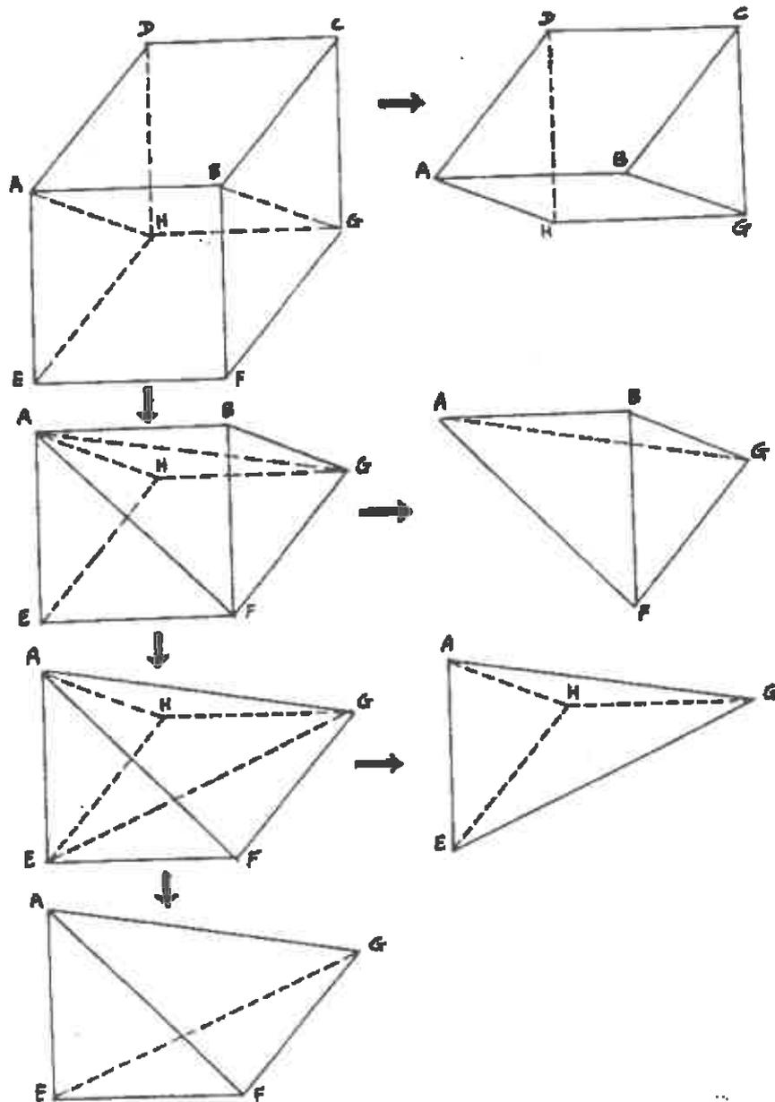
La procédure du problème 5-15 explique comment calculer le volume du *yangma* : « La largeur et la longueur sont multipliées entre elles ; par la hauteur, on les multiplie ; on divise le résultat par 3. » Autrement dit,  $V = EF \cdot EH \cdot EA/3$ .
