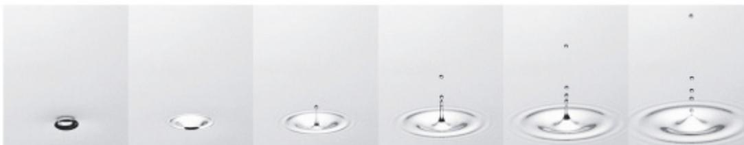
**Figure 4 :** Séquence qui illustre les détails de la production de gouttelettes engendrée par l'éclatement d'une bulle millimétrique dans de l'eau pure (Cliché E. Ghabache).
