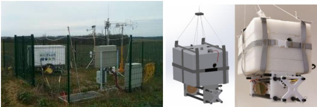
La station ECOFLUX déployée sur le site de Bures pour la mesure in situ des flux de N<sub>2</sub>O et les senseurs laser AMULSE pour le radiosondage de CO<sub>2</sub> et CH<sub>4</sub>.
