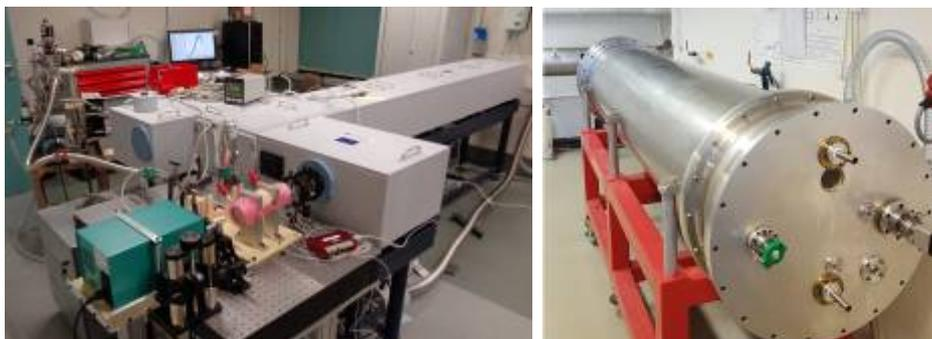
La nouvelle TF Bruker mise en œuvre pour la mesure de O<sub>3</sub> pour le programme de l'ESA et la cuve optique cryogénique pour l'analyse du méthane dans les conditions de Titan.
