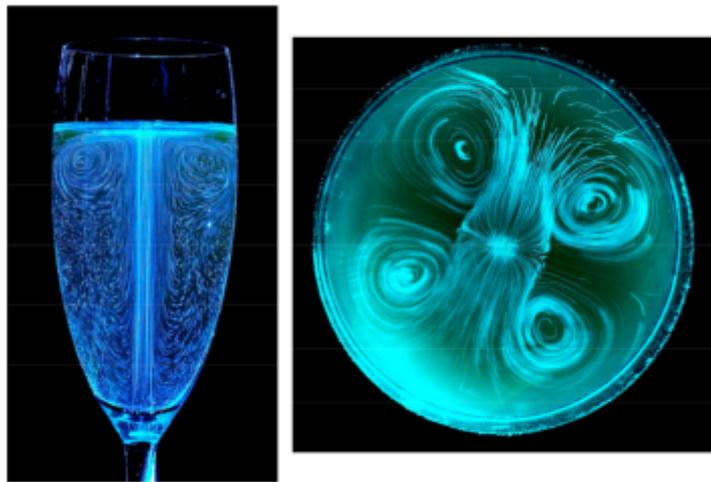
**Figure 6** : Lignes de courant, obtenues par tomographie laser, qui illustrent l'allure des tourbillons qui agitent le cœur du fluide (a) et sa surface (b).
