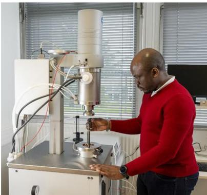
Diffusivimètre haute température
