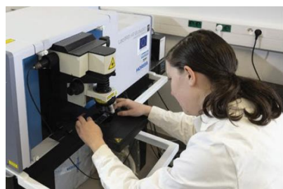
Observation d'une lame sur Spectromètre Raman
