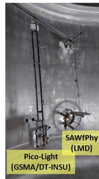
Figure 2: Photographie des hygromètres Pico-Light (GSMA/DT-INSU) et SAWfPhy (LMD), intégrés dans la chambre principale AIDA au KIT.
