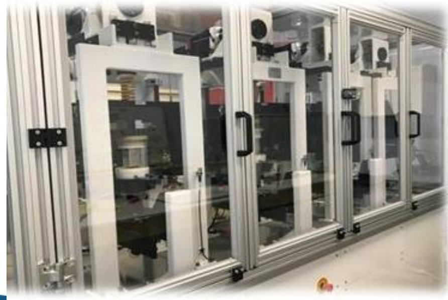
Banc d'usure 3 postes pour prothèses de genou
