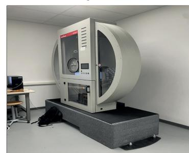
Machine d'impact par chute de masse
