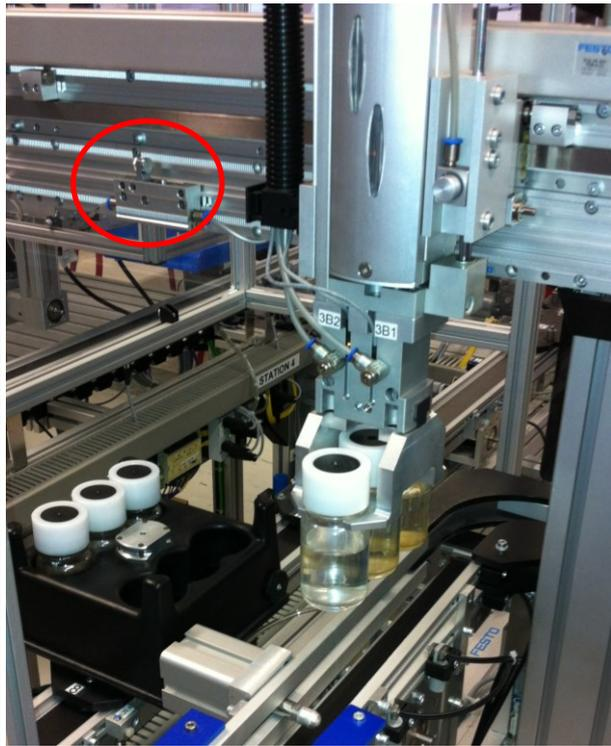
On déplace la pince au-dessus de la 1<sup>ère</sup> rangé du 6 packs, on effectue la dépose de la même manière que pour la 2<sup>ème</sup> rangé. On replace ensuite la pince du coté station de transfert pour terminer.
