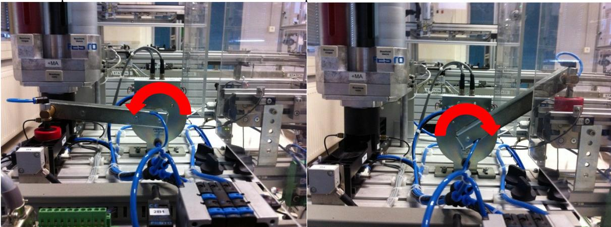
Il y a deux capteurs de position, un du côté magasin et un du côté convoyeur.
