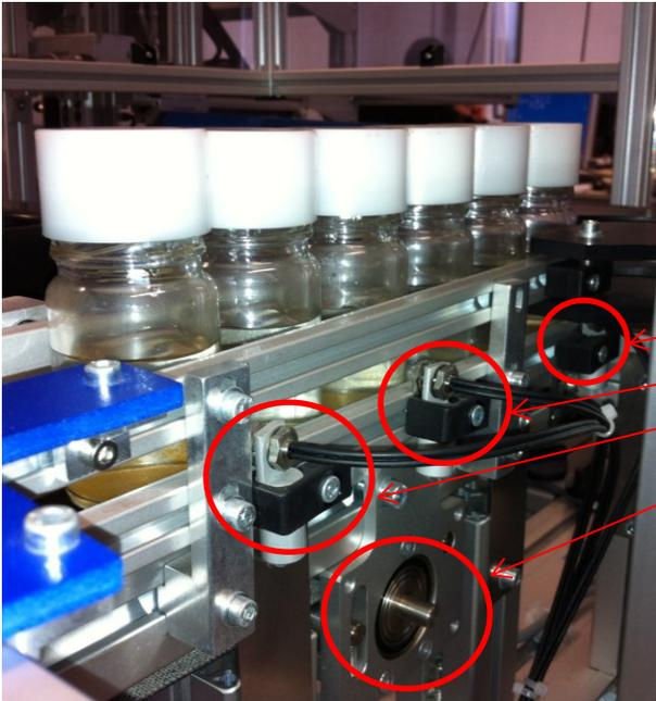
1 actionneur pour l'acheminement des bouteilles sous la pince de transfert.
