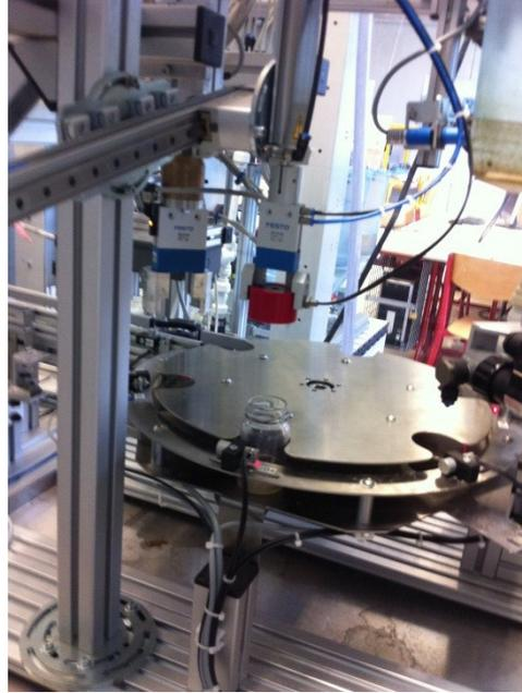
On descend le vérin de levage, on ouvre les pinces puis on remonte le vérin de levage.
