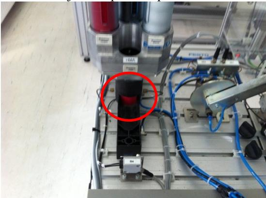
Il faut ensuite éjecter le bouchon du magasin. Pour cela, on active l'éjecteur jusqu'à sa sortie complète.
