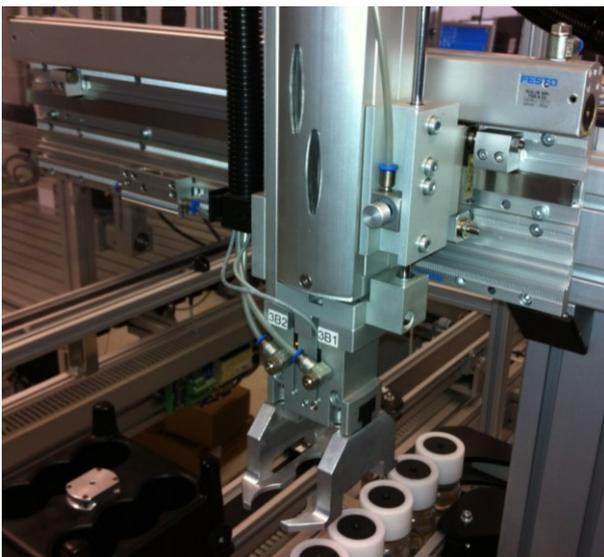
1 actionneur et 2 capteurs pour l'ouverture de la pince de transfert.
