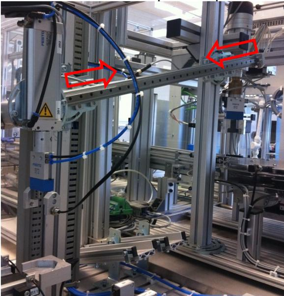
Ici, deux capteurs : un pour la position convoyeur et un autre pour la position embouteillage.
