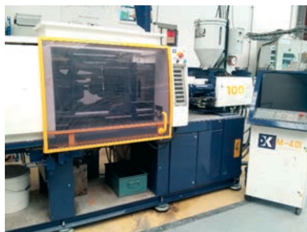
Presse à injecter
